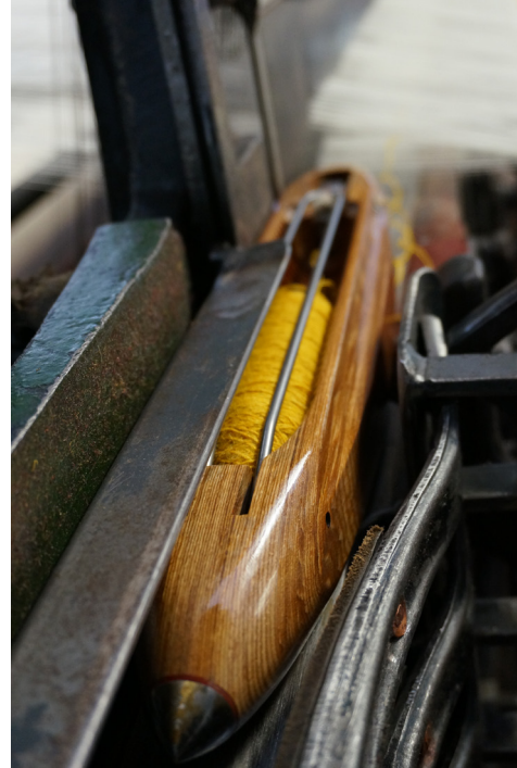
F.v.: filtemaskin frå 1920, teppeveving på jaquardvev. og skyttel til jaquardvev. Sjølingstad Uldvarefabrik.
